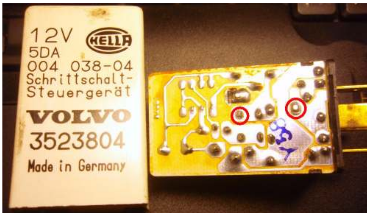
Figur 1. Relæ til overgear på AW71.
